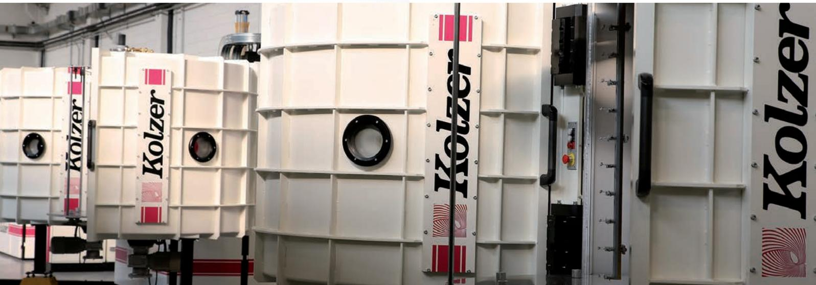
Les machines PVD KOLZER sont simples à utiliser, pour fournir la pulvérisation cathodique de base. Elles sont entièrement automatisées, numérisées et il est possible de les commander, même à distance. La machine intégrée à une ligne de peinture UV, permet la production à haute production dans la chambre sous pression, conformément aux spécifications du client et avec un très faible % de rebuts.
